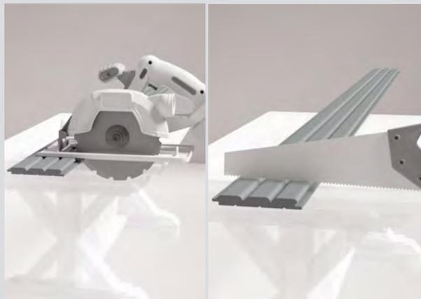
Обрежьте стеновые панели в соответствии с размерами вашей стены, используя пилу с упорными зубьями или ручную пилу. Будьте осторожны, чтобы не повредить панели при резке. Убедитесь, что после резки на краях и углах панелей нет вмятин.
